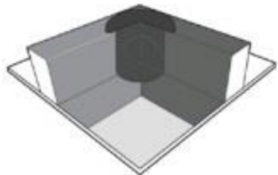
6) Soudage d'une pièce de finition haute
