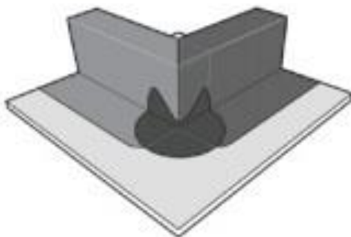
5) Pose de la pièce de renfort soudée
