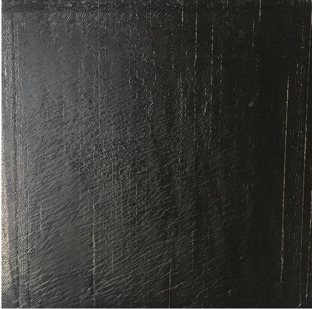
Figures 7 – Sous-face de la membrane RESITRIX MB
